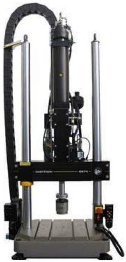
油壓雙軸材料動態試驗機
