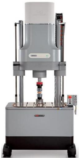
機電雙軸材料動態試驗機
