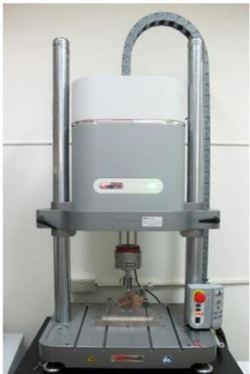
機電軸向材料動態試驗機
